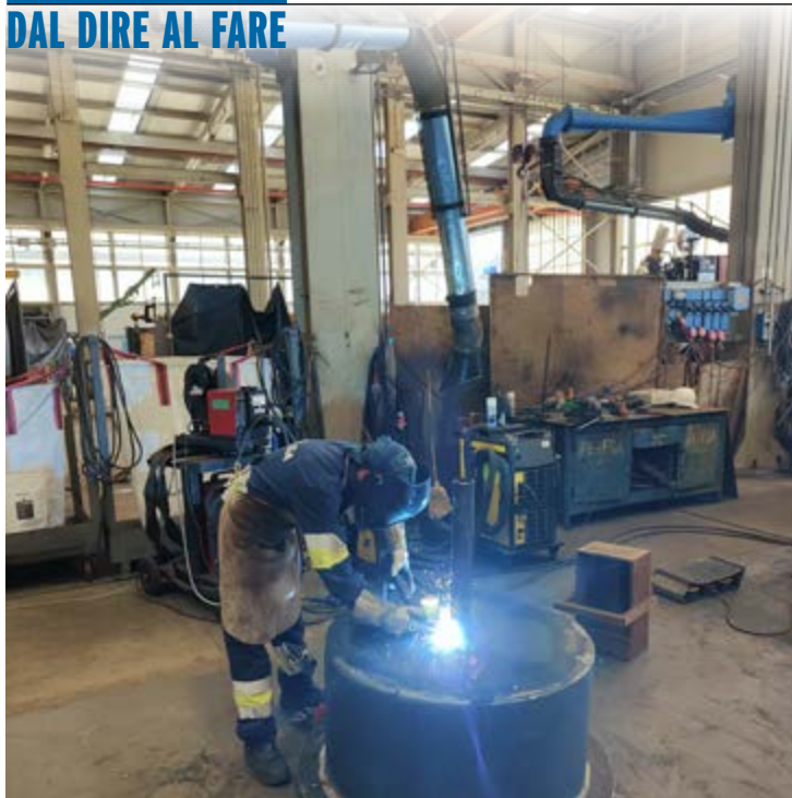
Sono 11mila le tonnellate di lamiera che vengono lavorate tramite ossitaglio, taglio plasma, saldatura, calandratura e stampaggio
